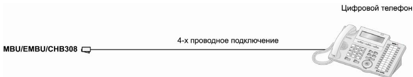
Рис. 2.21 Подключение цифрового аппарата и консоли DSS
